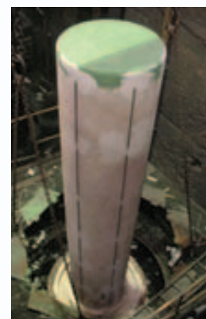
Moulage d'un tambour d'enrouleuse Ø1250mm x 8000mm Moulding of a Ø1250mm x 8000mm reel drum
