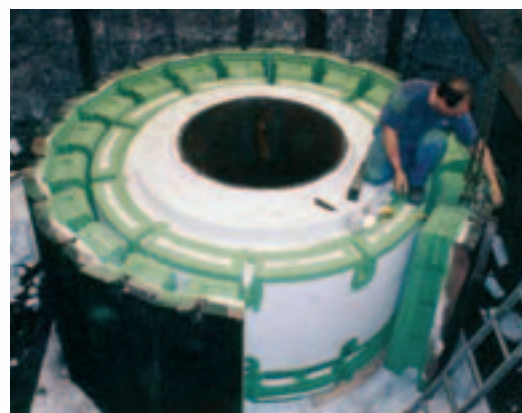
Moulage d'un tambour spécial en EN GJS 500-7 Ø2900 - poids: 14 tonnes
