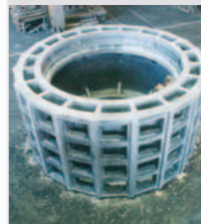
Tambour spécial en EN GJS 500-7 Ø2900mm - poids : 14 tonnes Ø2900mm x 14 MT special drum EN GJS 500-7
