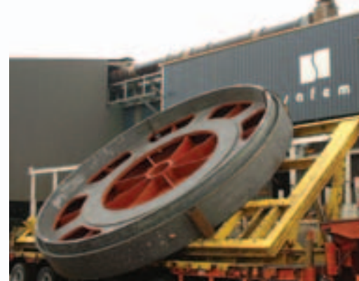
Plateau de tour vertical en EN GJL 300 - Ø6000mm - poids: 38 tonnes Ø6000mm - 38 MT vertical lathe plate, EN GJL 300
