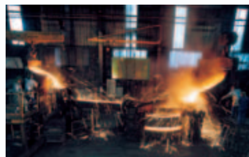
Coulée à 2 poches d'un YANKEE 3200x3600mm - Poids : 40 tonnes 2 laddles casting of a 40 MT YANKEE SHELL Ø3200x3600mm
