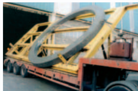
Couronne d'emboutissage en EN GJL 300 Ø4400mm - poids : 9 tonnes Forming tool crown Ø4400mm x 9MT EN GJL 300
